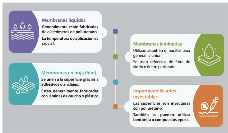
Figura 2. Tipos de membranas y sus características.
