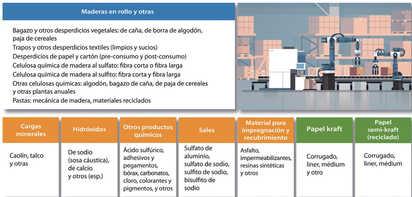
Figura 1. Insumos para la fabricación de cartón y cartoncillo a partir de pulpa.
