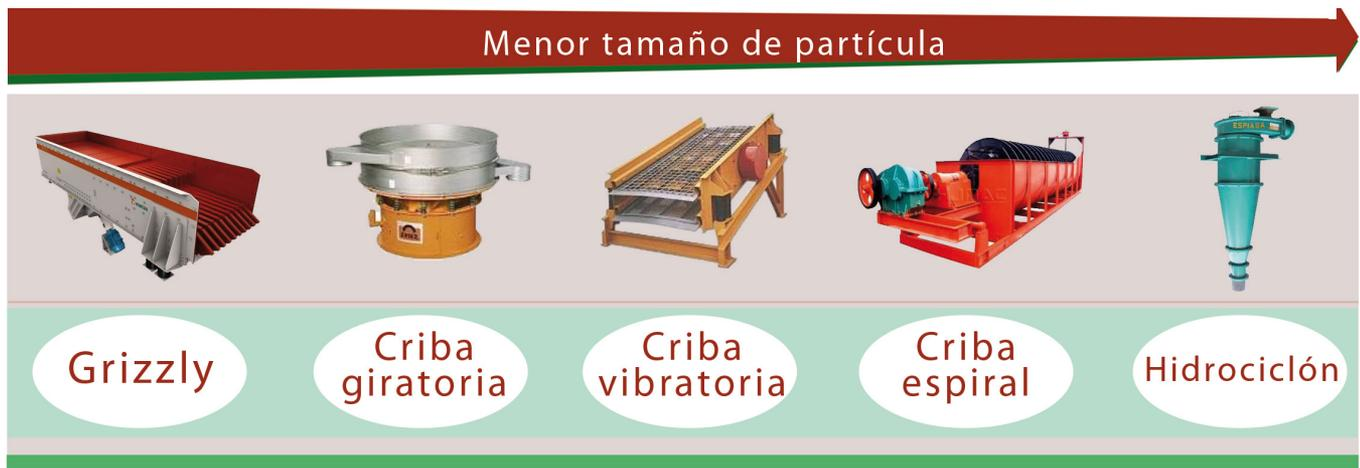
Figura 7. Equipo utilizado en la separación de partículas.
