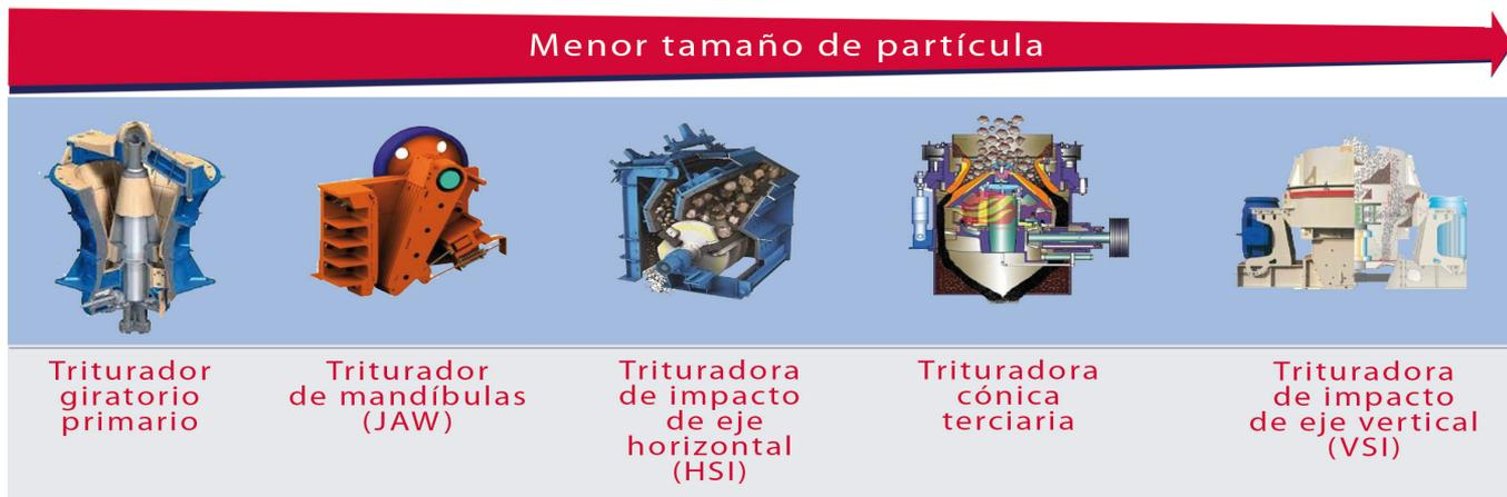
**Figura 3.** Equipo utilizado en la trituración de rocas.
